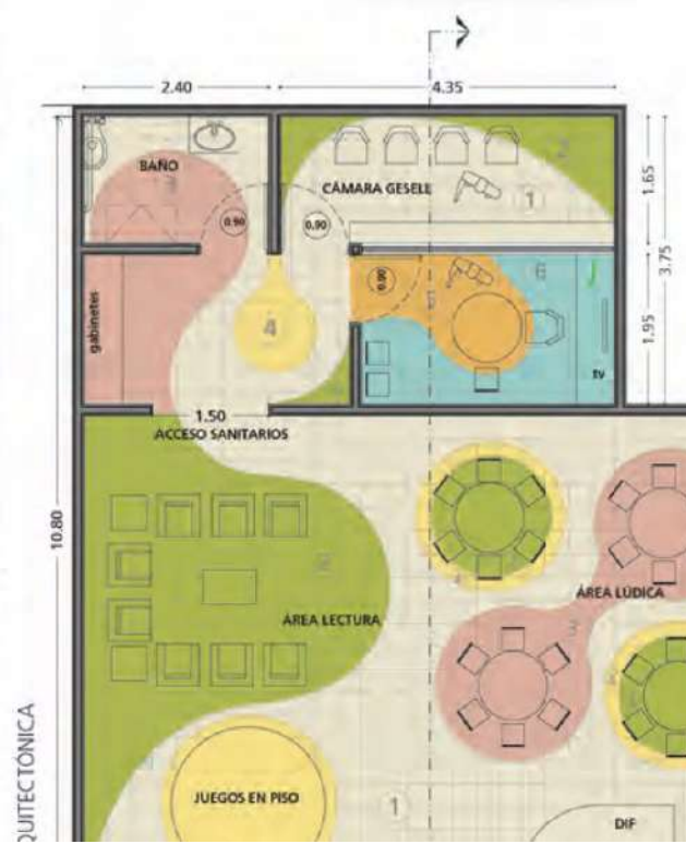
Imagen 12. Opción 1 para el módulo de atención (área lúdica y recreativa, sala de atención psicológica infantil y cámara de Gesell): planta arquitectónica, plano de plafones e iluminación, diseño de muros y render (CONAVIM & ONU-HABITAT, 2015, págs. 111-114)
